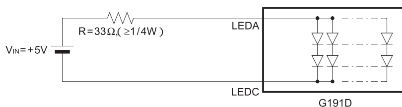
図 15 LED バックライト駆動回路例 1
